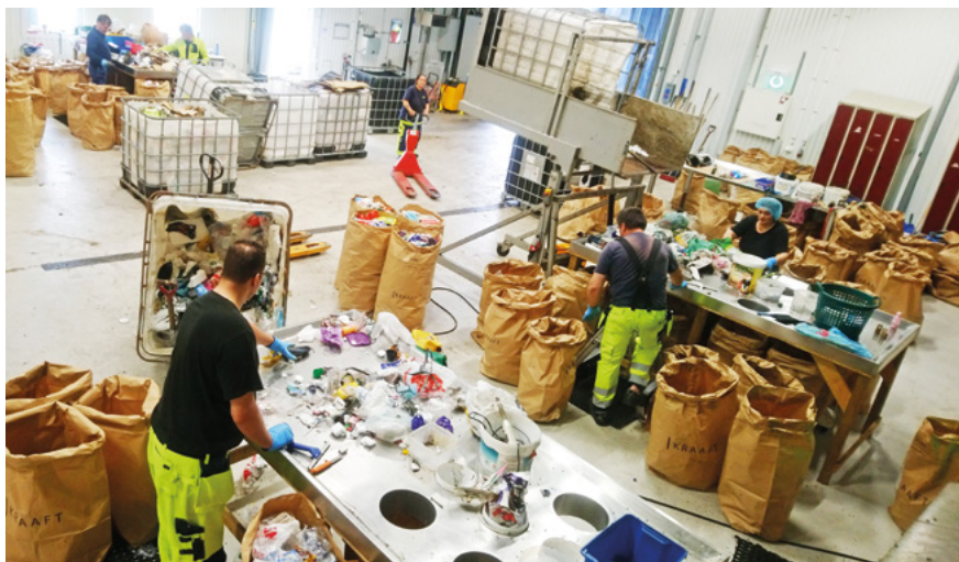
Figur 2. Plockanalys: avfallet sorteras för hand på avfallslaboratorium i Helsingborg. Foto: Envir Plockanalyser AB, 2016.
